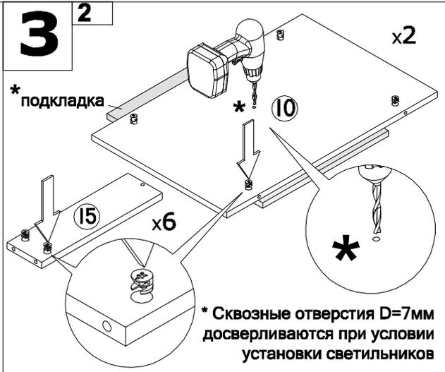
\* Сквозные отверстия D=7мм досверливаются при условии установки светильников
